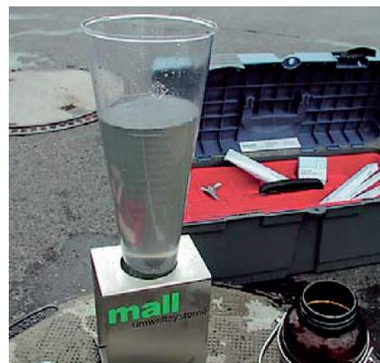
Der Richtwert für absetzbare Stoffe beträgt nach DWA-Merkblatt 115 zwischen 1 und 10 ml/l. Abweichungen in den kommunalen Abwassersatzungen sind möglich.
