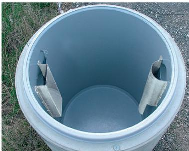
Beim Einbau des Fettabscheiders ist die Variante Erdeinbau prinzipiell die beste und sinnvollste Entscheidung. Der Einbau wird durch einen qualifizierten Bauunternehmer durchgeführt. Die Einbaustelle sollte u.a. in der Nähe der Anfallstelle sein, nicht in der Nähe von Aufenthaltsräumen und Fenstern liegen und für Reinigungsfahrzeuge leicht erreichbar sein.
