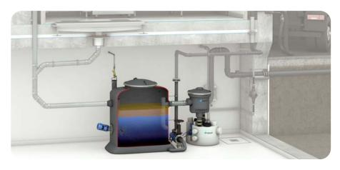
prozesse in der Anlage entstehen Gase, vor allem Schwefelwasserstoff, der in Verbindung mit Wasser zu aggressiver biogener Schwefelsäure wird und nicht säureresistente Bauteile angreift.
