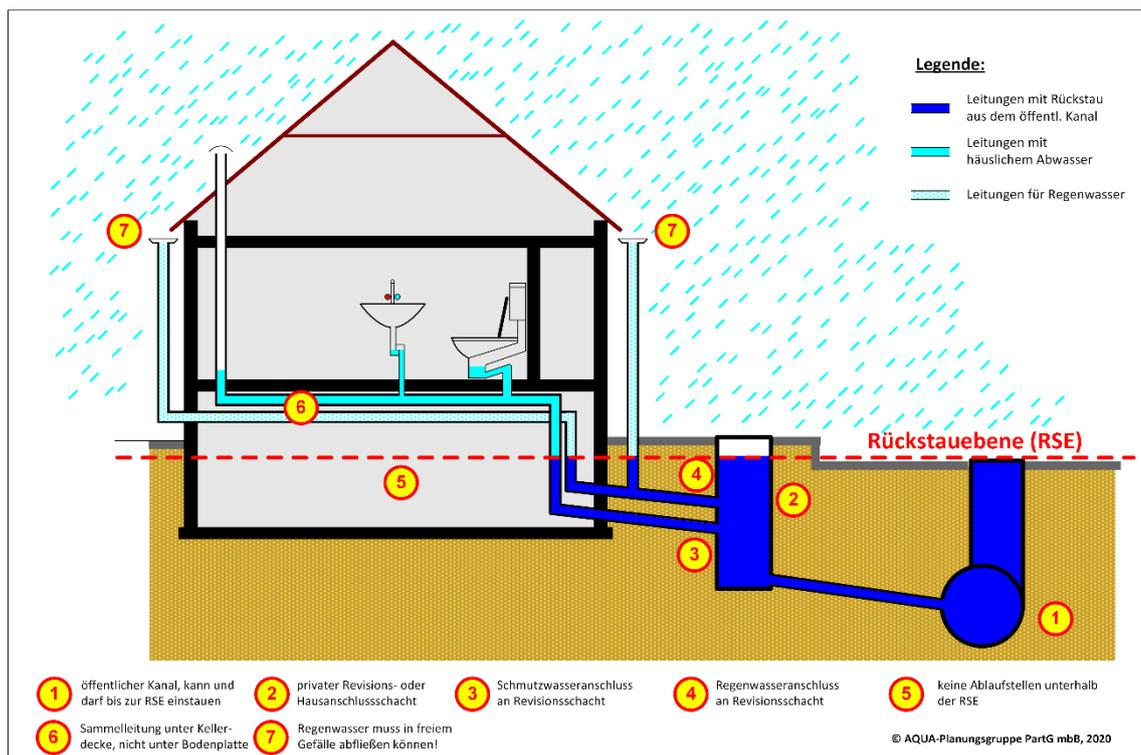
Für Gebäude ohne Keller stellt diese Situation in den meisten Fällen den Normalfall dar. Ein Rückstauschutz wird bei diesen Gebäuden erst dann erforderlich, wenn der Erdgeschossfußboden unterhalb der Rückstaebeane liegt.
