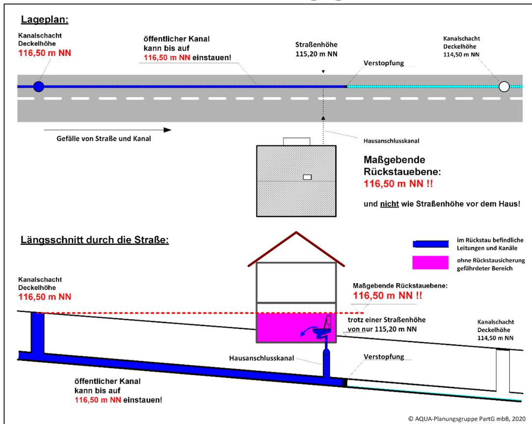
In diesem Beispiel wird die Höhe der Rückstauebene durch die Höhe des bergauf liegenden Kanalschachtes definiert, d.h. dies ist die erste Stelle, an der das Wasser aus dem Kanalnetz auf die Geländeoberfläche austreten kann. Die maßgebende Höhe kann aber auch durch einen an den Kanal angeschlossenen Straßeneinlauf definiert werden, wenn dieser zwischen Anschlussstelle und dem oberhalb liegendem Schacht liegt.
