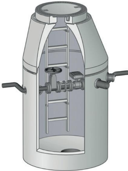
Zur exakten Bestimmung der Durchflussmenge ist der Mall-Mengenmessschacht LevaCheck die ideale Wahl. In der Anlage ist ein hochwertiges magnetisch-induktives Durchflussmessgerät für vollgefüllte Leitungen – bestehend aus einem Messaufnehmer und -umformer (Auswertegerät) – verbaut, das für alle Abwasseranwendungen geeignet ist.
