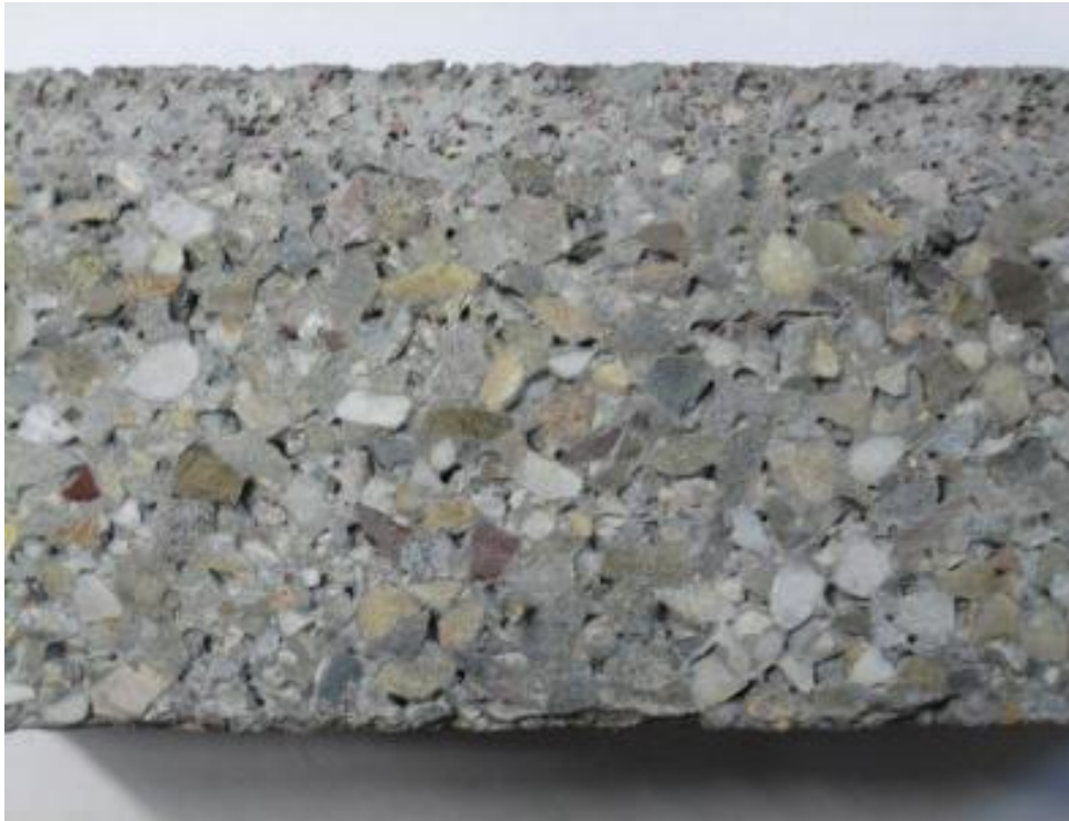
Haufwerksporiger Pflasterstein – nach DIN 18507
