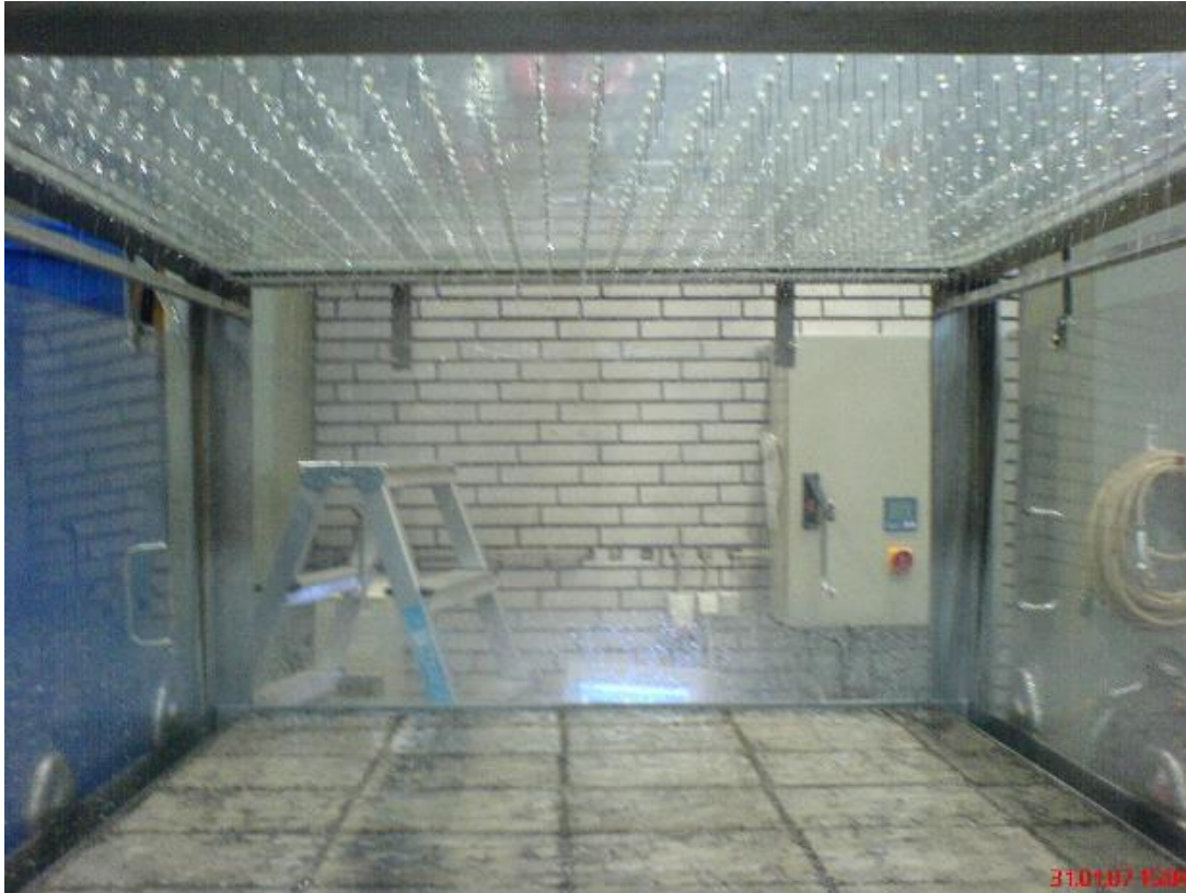
Beregnung der Pflasterfläche
